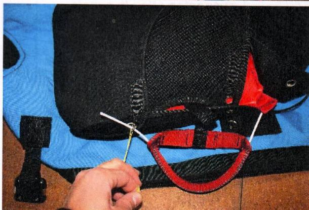
Insérer l'aiguille de la poignée dans la boucle. Puis retirer la ficelle d'installation. Glisser l'aiguille dans le fourreau situé sur le dernier panneau.
