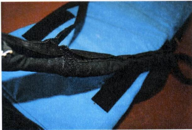
Pour finir, placer la protection UV le long de la sangle parachute et de la porteuse.
