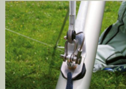
Querrohrspannseil und hintere Oberverspannung werden am selben Beschlagteil am Kielrohr eingehängt.
