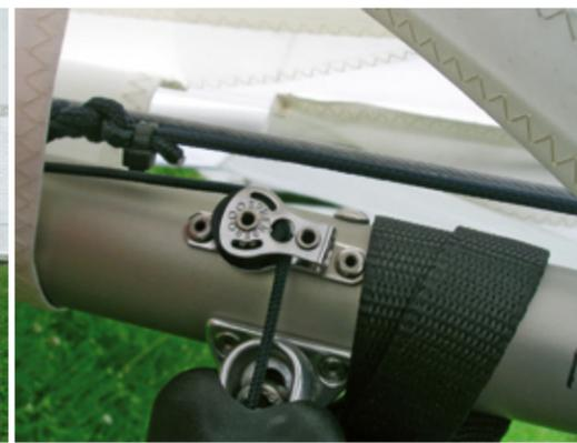
Kugelgelagerte Umlenkrollen sorgen für eine leichtgängige variable Geometrie
