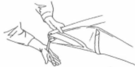
**10/** Agganciate la leva allo steccone e mettete in tensione la vela ruotando la leva verso l'interno. Accertatevi che la leva poggi sullo steccone. Chiudete la cerniera.
