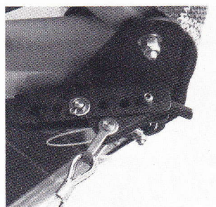
Réglage de position de trapèze Mise à plat par simple push pin
