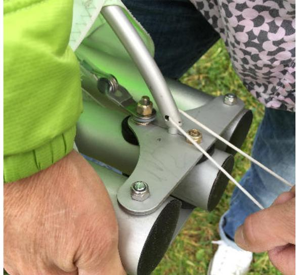
**Segelfläche ausbreiten:** Schiebe nun die Segellatten von innen nach aussen (d.h. von Latte 1 beginnend) in die Segellattentaschen und sichere diese mit den Lattenclips und den Lattenschnüren. Nachdem Du die Obersegellatten eingeschoben hast, kannst Du das Gerät mittels Kabel spannen und am Kielverschluss einrasten lassen.
