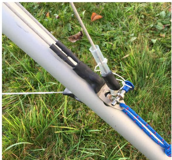
Danach wird der Sicherungsverschluss des Oberriggs ebenfalls dort eingehängt und mittels Quickpin gesichert.
