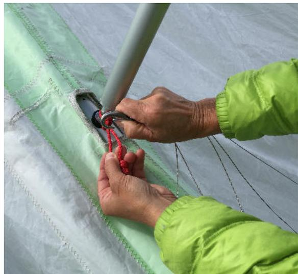
Klappe den Turm nach vorne. Klappe die Segelhälften Zug um Zug zusammen. Rolle die Segelhälften ein und sichere die eingerollten Segelhälften mit einem Klettband. Schliesse die Klettbinden nicht zu fest, damit sich keine bleibenden Falten bilden. Ziehe den Packsack über das auf der Speedbar stehende Gerät und schliesse den Packsackreissverschluss von vorne bis zum Trapez. Lege das Gerät anschliessend auf den Rücken und demontiere die Speedbar. Schiebe die Trapezschutztasche über die Trapezecken.
