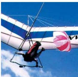
Le drag-chute procure un plus significatif en terme de sécurité lors des phases de retour au sol. Le drag-chute original TECMA ne tourne pas sur lui-même et ne faseye pas. Développé pour les pilotes de compétition, le drag-chute ne réduit pas la vitesse d'atterrissage mais divise la finesse par 2 à 50 km/h, rendant plus aisée la construction d'approche sur petits terrains.
