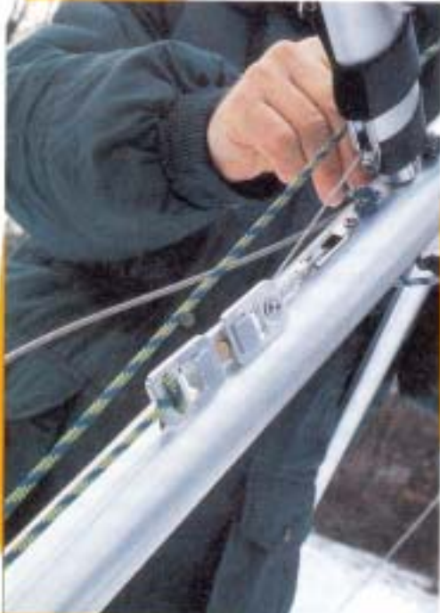
Kompensatorhaken mit Tastenverschluss: verbindet Kompensator, VG-Seil und Querrohrseil
