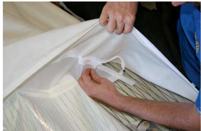
**Bild 12: Zellwand-Reißverschluss öffnen**
