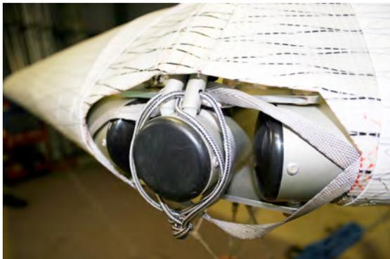
**Aufsetzen der Nasenlatten.** Setze die Nasenlatten auf die dafür vorgesehenen Stifte auf dem Kielrohr. Wenn du es vor dem Spannen des Drachens vergessen hast, solltest du die VG voll anziehen, bevor du sie dann einsetzt.
