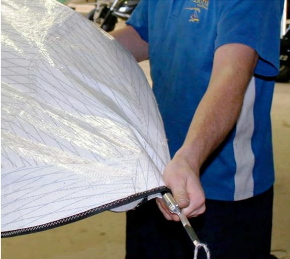
**Spannhebel einhängen.** Stell dich vor den Flügel. Für den rechten Randbogen hältst du die Eintrittskante mit der rechten Hand und das Segelende mit der Linken (beim linken Flügel umgekehrt). Biege nun den Randbogen in Richtung Flügelhinterkante und schiebe die Hülse des Spannhebels über den Randbogen.
