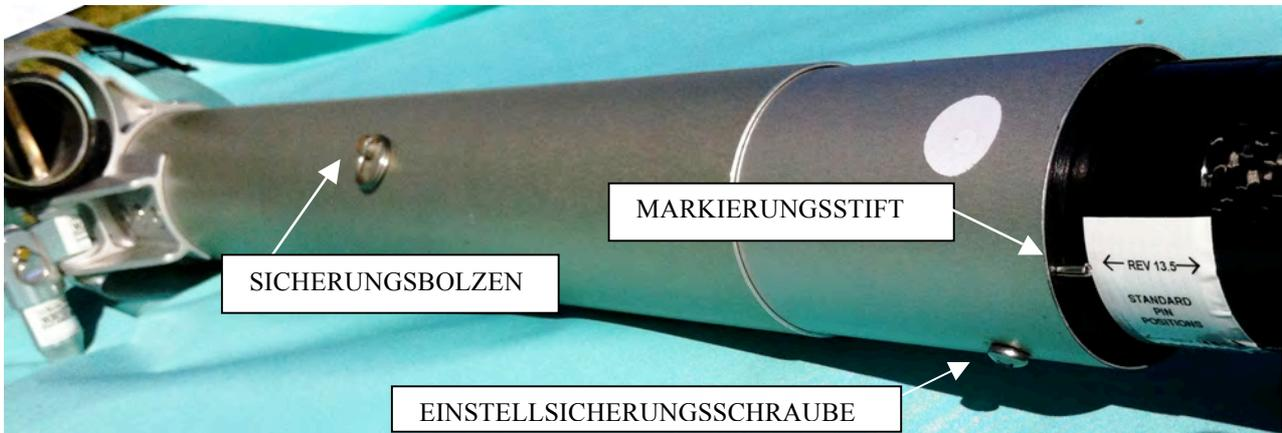
**Bild 13: Ausrichtung des äußeren Flügelrohrs**
