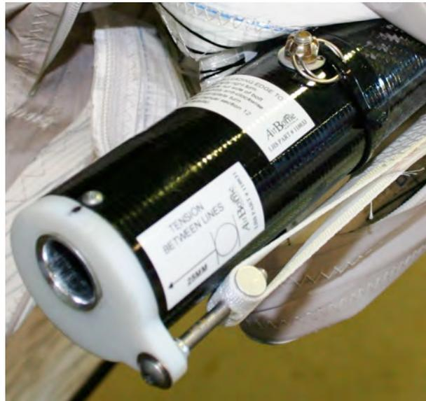
**Bild 26: Einstellung der Segelspannung**
