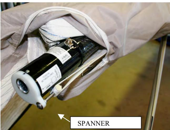
**Segelspanner einhängen.** Der Justierknebel wird von der M5-Schraube abgeschraubt und in die Schlaufe des Segels eingelegt. Dann wird die Schraube wieder in den Knebel geschraubt. (Das Foto zeigt das linke äußere Flügelrohr)
