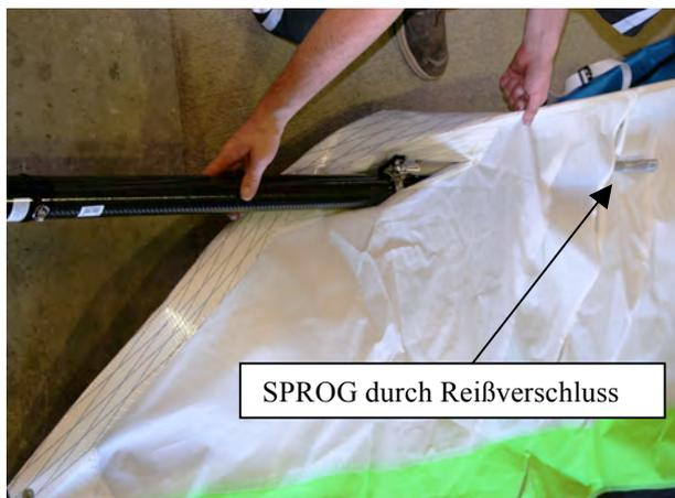
**Einsetzen der äußeren Flügelrohre.** Schiebe das äußere Flügelrohr durch den äußeren Reißverschluss, der Sprog liegt in Einschubrichtung. Wenn du das Rohr einschiebst, achte darauf, dass der Sprog durch den Reißverschluss des äußeren Sprogs herauskommt. Achte auf die richtigen Seiten (links und rechts sind auf den Rohren gekennzeichnet).
