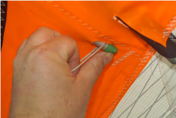
**Untersegellatten einschieben.** Die Untersegellatten sollten so weit wie möglich eingeschoben werden. Dann drückst du das Ende mit dem Daumen in die Tasche und ziehst die Latte mit dem Band bis in das hintere Ende der Tasche hinein.
