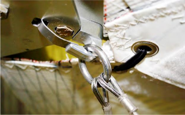
**Vordere Unterverspannung einhängen.** Achte darauf, dass die Verspannung gesichert und der Schnellverschluss eingerastet ist.
