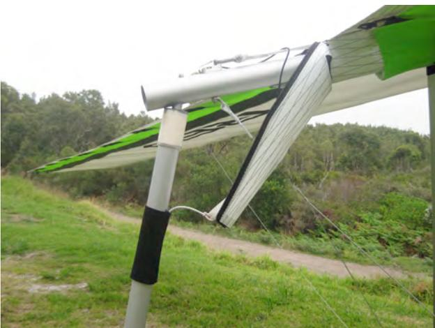
**Auf „Keel Stand“ aufstellen.** Die hintere Kielrohrverlängerung kann durch die Öffnung am unteren Ende des Kielrohrs herausgezogen und eingesetzt werden. Dadurch „steht“ der Drachen, die Randbögen sind gehoben und das Einschieben der Segellatten wird vereinfacht. Der „Keel Stand“ sollte nur bei leichtem Wind und ebenem Untergrund benutzt werden, ansonsten wird möglicherweise das Kielrohr beschädigt.
